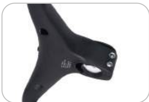
ROTA DE CABOS INTERNOS
