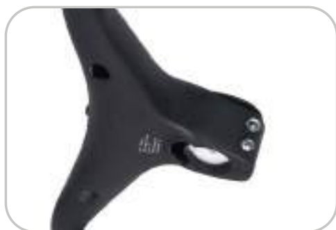
ROTA DE CABOS INTERNOS
