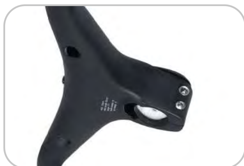
ROTA DE CABOS INTERNOS
