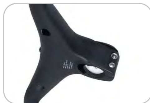
ROTA DE CABOS INTERNOS
