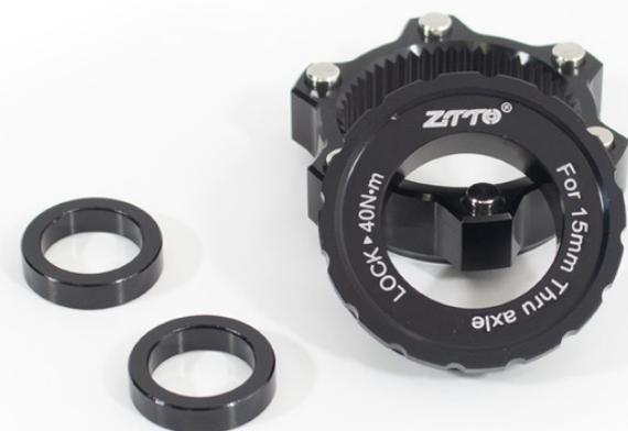
**ADAPTADOR CENTERLOCK PARA 6 PARAFUSOS 15X100 PARA 15X110**
