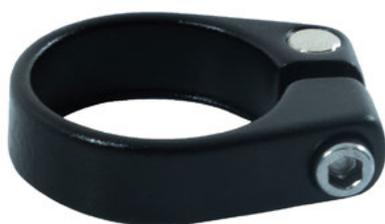
**ABRAÇADEIRA MTB**Material                      AlumínioCaracterística                      Ajuste parafusoTamanho                      31.8Peso (kg)                      22g
